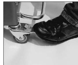
Gerät durch Feststellbremse gegen Wegrollen sichern.
