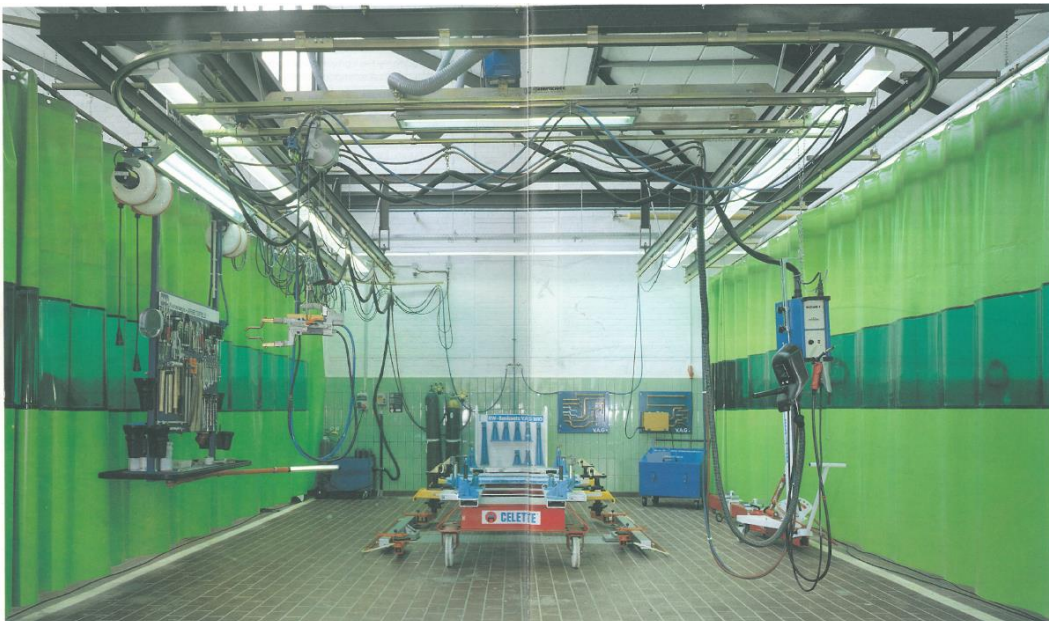
Bild: Stahl-Karosseriearbeitsplatz VAG 1647 R, Stand 1989
