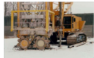
Schlitzwandfräse für den Bau der Dichtwand
